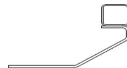
Verbindungsrohr zw. Längsrahmen für Befestigung Ölwannenschutz:
